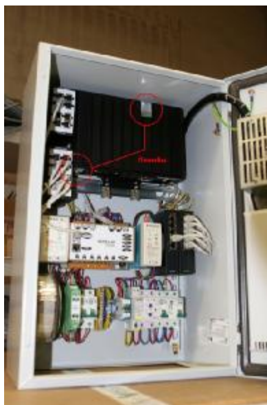
Рисунок 2 – Внешний вид вычислительного блока с указанием мест пломбировки
